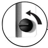
Dispositif permettant de verrouiller ou déverrouiller le porte filtre.
