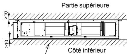
Une trappe de maintenance du côté inférieur est nécessaire pour procéder à l'entretien et à la maintenance.
