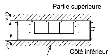
Une trappe de maintenance du côté inférieur est nécessaire pour la maintenance et l'entretien (pour atteindre le filtre, le moteur du ventilateur, etc.).
